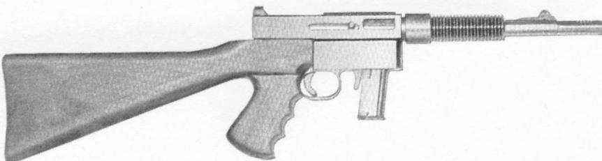
mit Mündungsbremse (Kompensator) und Rippenkühlmantel - Konstruktion und Ausführung wie alle „JGL-Automaten 65/68“ jedoch nur mit Hinterschaft wie M 102 und 190 mm langem Lauf. Trotz seiner Kürze mit hervorragender Schußleistung! Dieses Modell ist mit Loch- und offenem Visier ausgerüstet (Einblattsystem).
